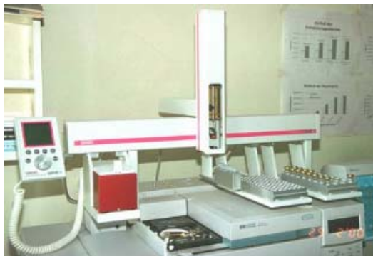
Fig. 1 : Appareil HS-SPME / GC-MS permettant une analyse qualitative systématique des additifs volatiles (à gauche) et électrode sélective d'ammoniac pour prouver la présence d'ammoniac et d'urée (à droite)
